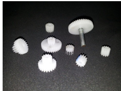
Engranajes de caja reductora
